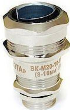
Кабельный ввод для металлорукава ВК-М-МР предназначен для герметичного ввода кабеля, проложенного в металлорукаве, в металлический корпус электрооборудования (щиты, шкафы, коробки и др.) и обеспечения надёжного электрического контакта между металлическим корпусом и металлорукавом в соответствии с п. 1.7.77 Правил устройства электроустановок. В конструкции кабельного ввода предусмотрена
