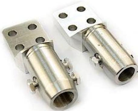
**Наконечники соединительные НС** (Наконечники симметричные) изготовлены из алюминиевого сплава и предназначены для оконцевания алюминиевых и медных жил большого сечения для кабелей с бумажной и пластмассовой изоляцией на напряжение от 10 до 35 кВ. Для увеличения долговечности контакта на контактные поверхности болтов нанесена токопроводящая смазка.
