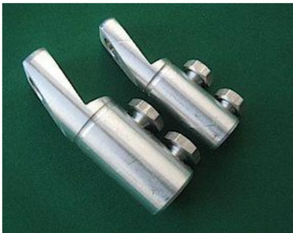
Наконечники двухболтовые кабельные 2-НБ предназначены для оконцевания алюминиевых и медных жил проводов и кабелей. Закрепление наконечника на жилах проводов и кабелей осуществляется методом завинчивания алюминиевых болтов со специальными срывными головками, которые скручивается при достижении определенного усилия, обеспечивая надежное соединение. Для увеличения долговечности контакта на контактные поверхности болтов нанесена токопроводящая смазка.
