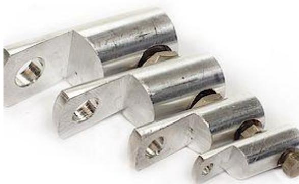
**Наконечники болтовые кабельные НБ** предназначены для оконцевания алюминиевых и медных жил проводов и кабелей. Закрепление наконечника на жилах проводов и кабелей осуществляется методом завинчивания алюминиевого болта со специальной срывной головкой, которая скручивается при достижении определенного усилия, обеспечивая надежное соединение. Для увеличения долговечности контакта на контактные поверхности болтов нанесена токопроводящая смазка.
