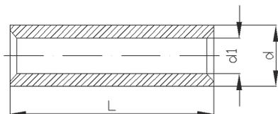
Гильзы кабельные соединительные медные ГМ, предназначены для соединения проводов и кабелей с медными жилами методом опрессовки.
